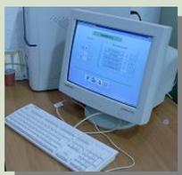
L'interfaccia con l'operatore è realizzata tramite una serie di pagine grafiche che consentono all'operatore di accedere alle funzionalità di tutti i quadri collegati.
